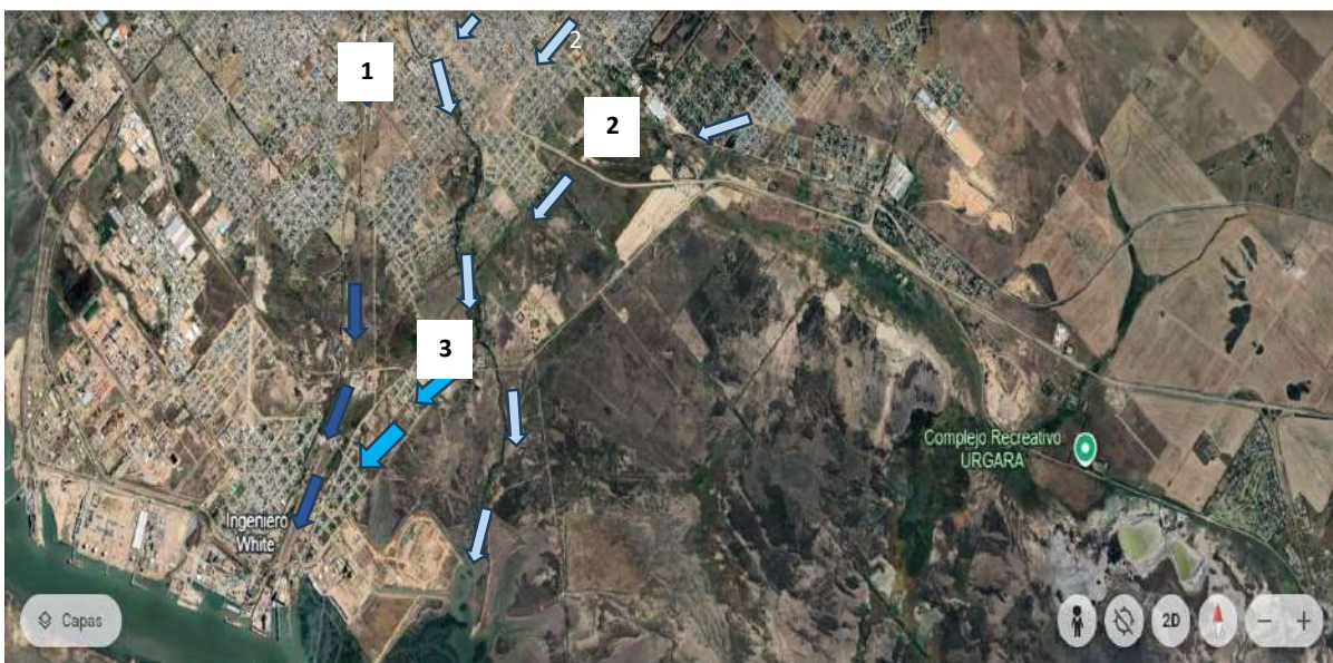
Figura 4. Corrientes de escorrentía en Sitio 1, 2 y 3 hacia Ing. White que provocaron su inundación
