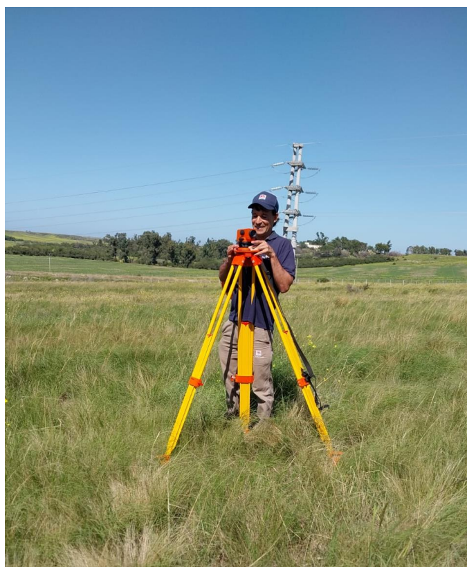
Foto 12, 13 y 14. Mediciones de curvas de iso nivel en pendientes hacia el arroyo Napostá equipo INTA-UNS Agronomía.
